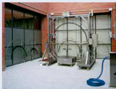
Equipo multinorma ensayos estanqueidad lluvia. Control central. Plataforma giratoria
