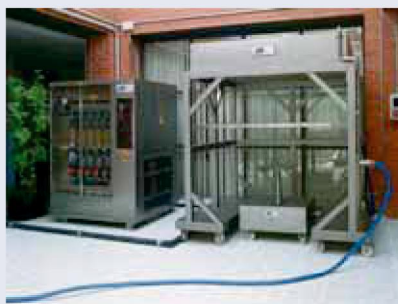
Equipo multinorma ensayos estanqueidad lluvia. Control central. Plataforma giratoria
