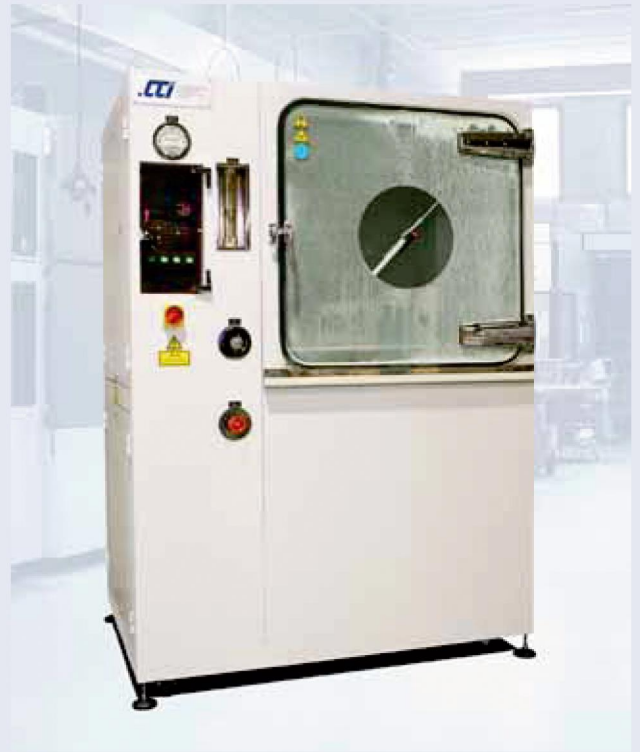
Cámara multinorma para ensayos de estanqueidad al polvo
