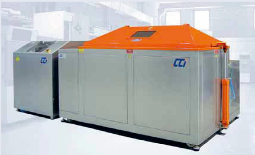
Cámara de ciclos climosalinis, con capacidad 2000 litros y unidad de control periférica
