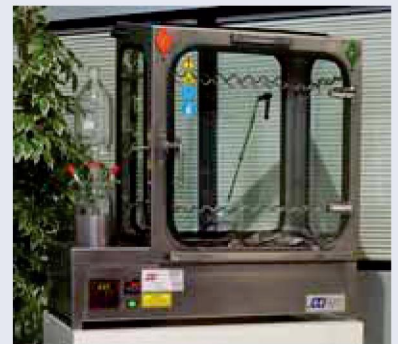
Corrosión sulfúrica. Kesternich
