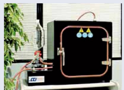
Corrosión niebla ácida. Inox. teflonado
