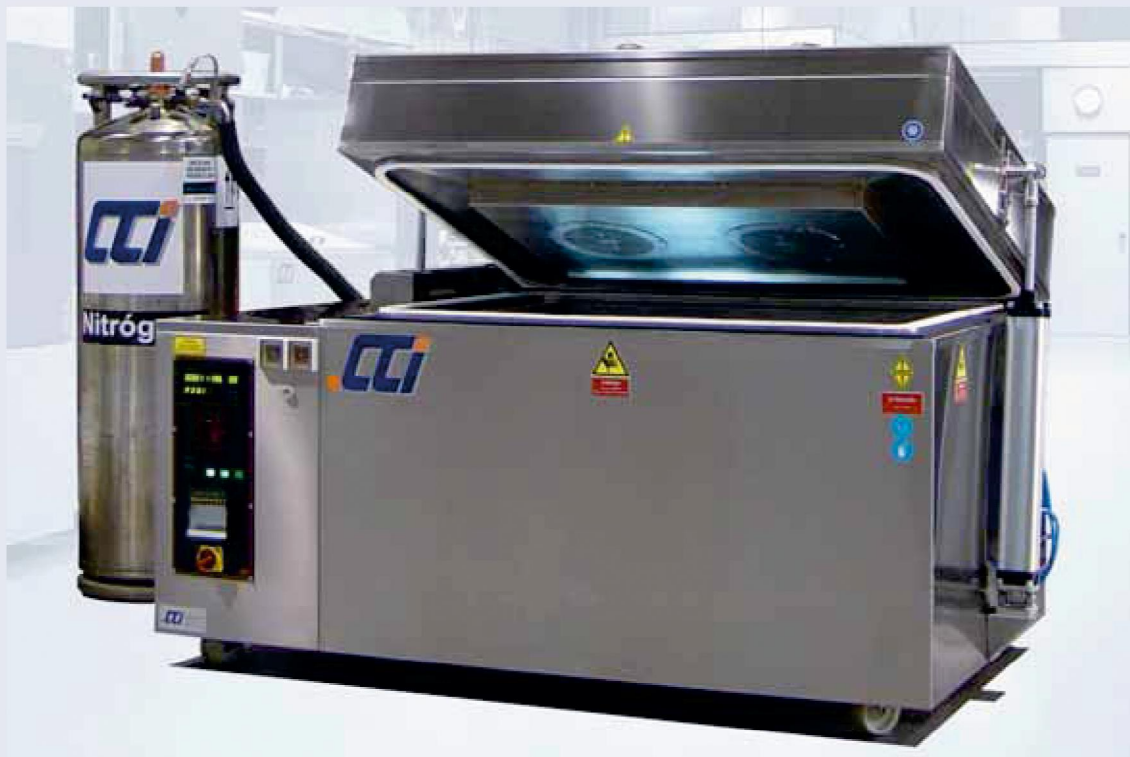
Cámara de ciclos ultracriogénicos hasta -196^{\circ}\text{C} para investigación y estudios de nuevas tecnologías. Inoxidable
